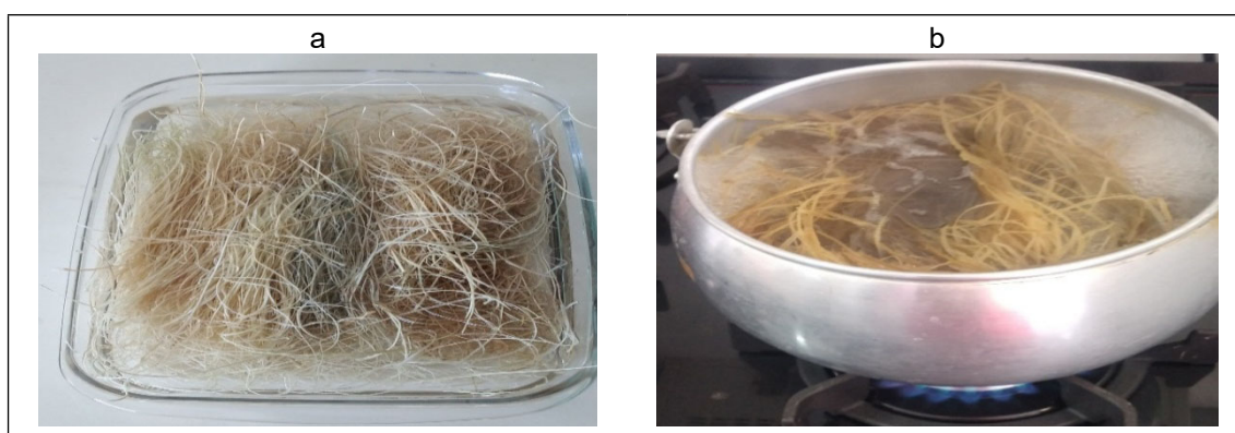
Figura 2. Tratamento alcalino das fibras com barrilha (a) e Limpeza das fibras com água fervente (b).
